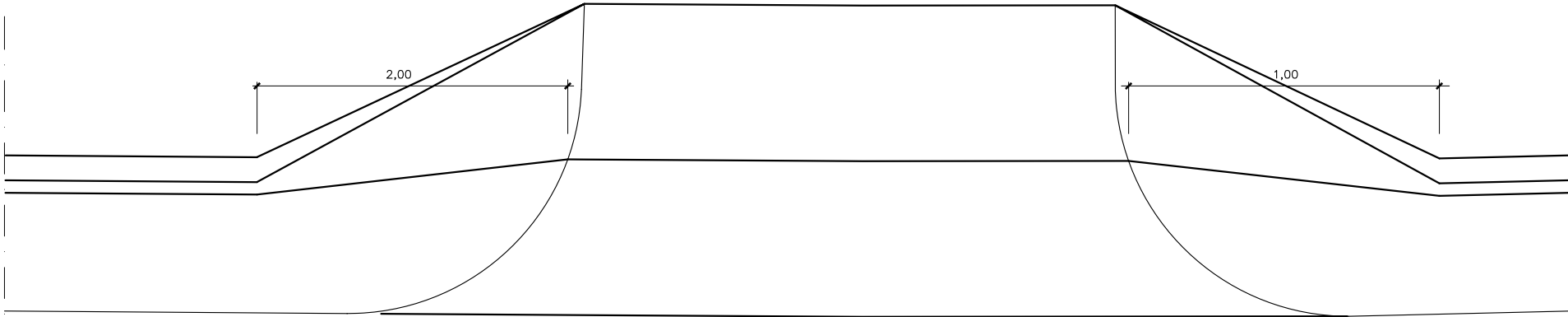
TRANSICION CUNETA DE 1,00m. A REBAJADA EN ACCESOS ESCALA 1/20
