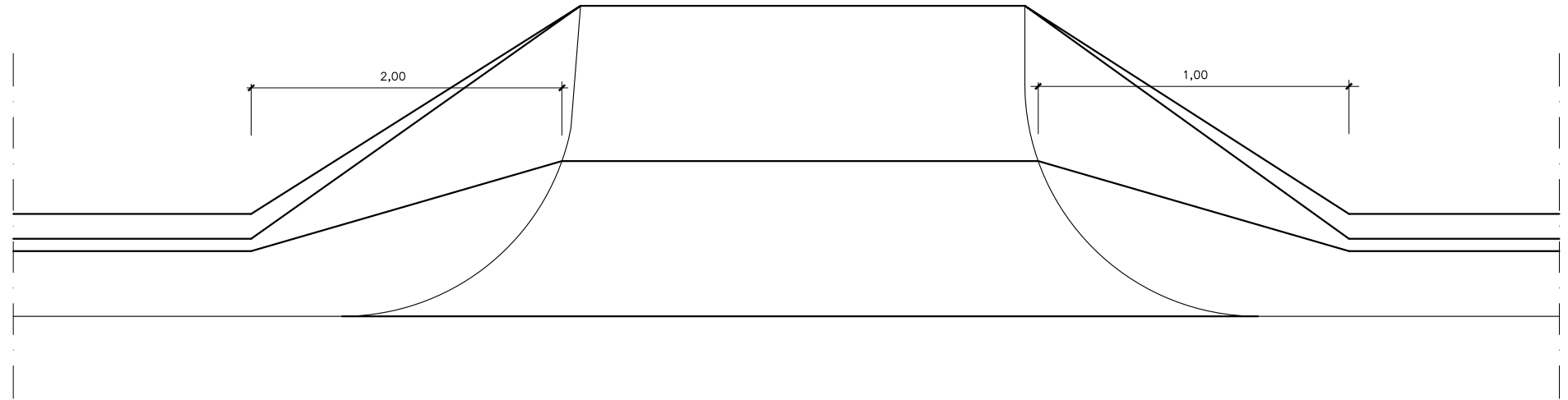
TRANSICION CUNETA DE 0,50m. A REBAJADA EN ACCESOS ESCALA 1/20
